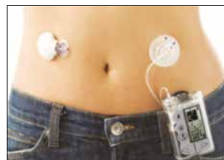
Figure 4: Exemple d'une pompe à insuline avec système MGC intégré (SAP).
